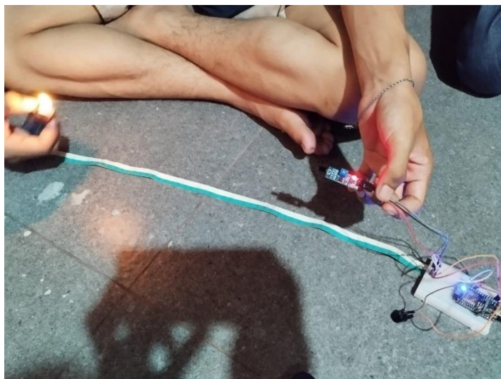
Gambar 16. Pengujian Sensor dengan korek Gas
