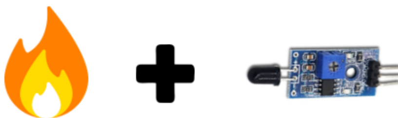
Gambar 15. Ilustrasi Pengujian Pada Sensor Api
