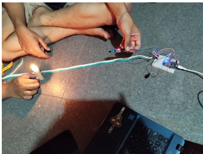
Gambar 17. Pengujian sensor dengan api pada lilin
